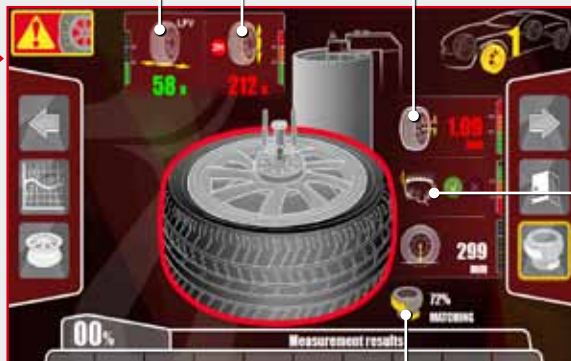
LFV Laterale Kraftschwankungen
