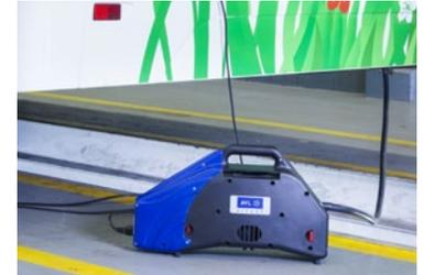
Kompakte, leichte und wartungsarme Trübungsmesskammer
